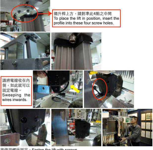
● <u>再使用螺絲固定。Fasten the lift with screws.</u>
