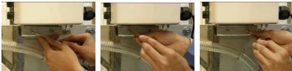
安裝升降機構軍規接頭 Connect the military plugs.
